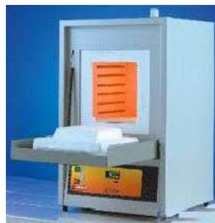
فرن الحرق يستعمل لحرق الراسب عند درجات حرارة عالية قد تتجاوز 1000^\circ\text{C}
