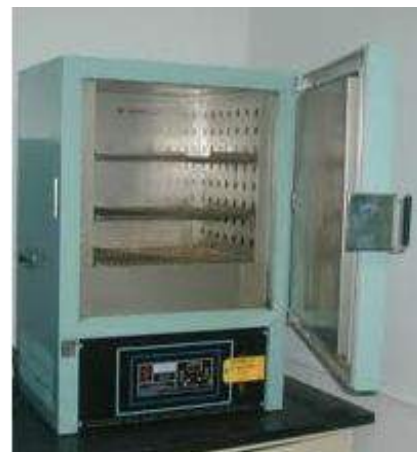
فرن التجفيف يستعمل لتجفيف الراسب عند درجات حرارة عالية قد تصل 100^\circ\text{C}
